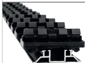
Der **GRAD® Alu Rail Start** ist ein nicht tragendes Aluminiumprofil mit vormontierten GRAD®-Clips, das sowohl auf ebenen Flächen als auch auf Holzunterkonstruktionen installiert werden kann. Es hebt die Dielen um 18 mm an (Unterprofil 12 mm + GRAD®-Clips 6 mm) und sorgt so für die notwendige Belüftung. Zum Entfernen der Dielen stehen spezielle Demontageschlüssel zur Verfügung. Diese Lösung ist ideal für kleinere Projekte, bei denen ein individueller Clipabstand erforderlich ist.
