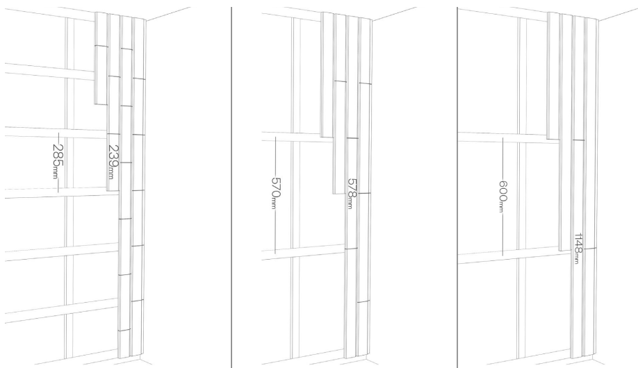
Tiles by Thermory -paneelien asennus pystysuoraan
