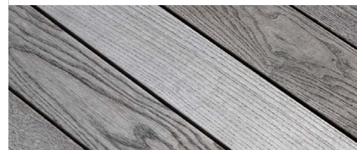
Õlitamata Thermory Benchmark termosaaress terrass 1 aasta möödudes
